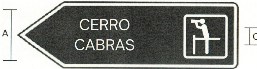
Señal Tipo O2 Señal Informativa de Pre-señalización de destino en vías peatonales 60 x 30
